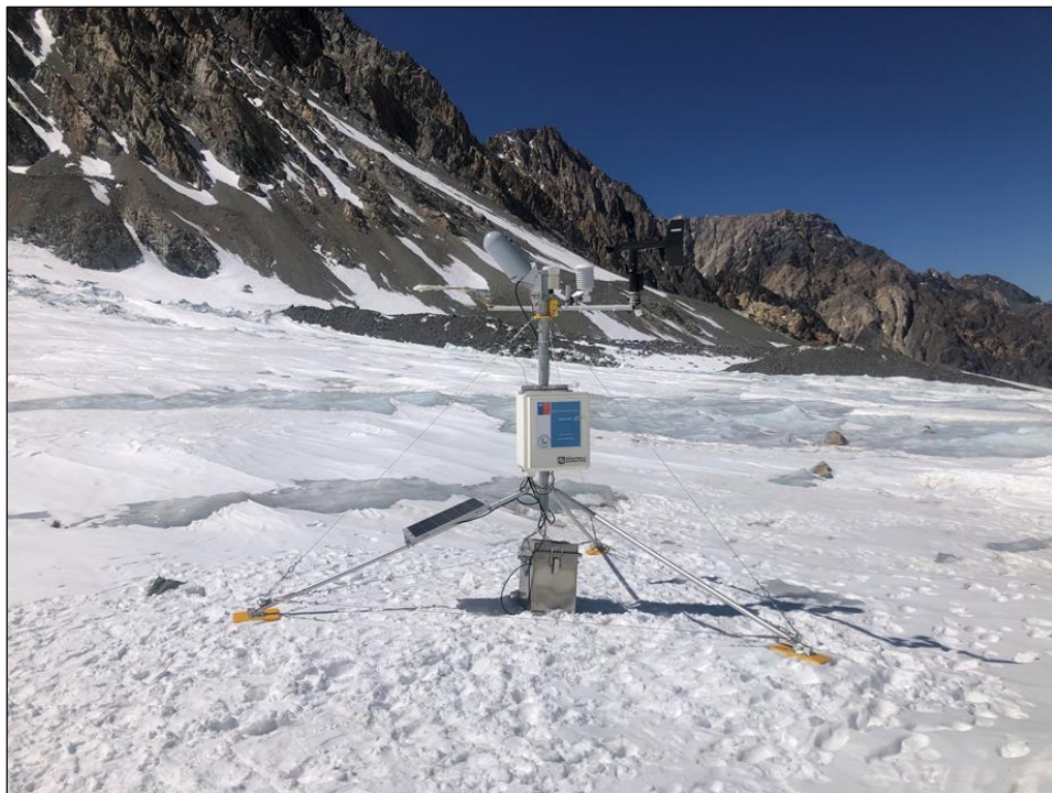
Figura 2 Estación Meteorológica Automática Móvil (EMAM), instalada sobre glaciar en época estival, Macrozona Glaciológica Centro.
